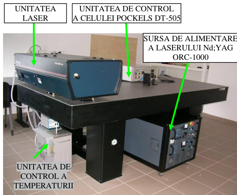
Fig. 2.12. Sistemul laser în femtosecunde CPA 2101
