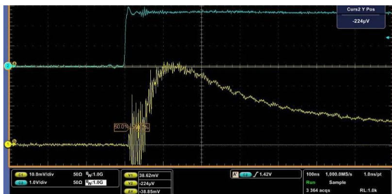
Fig.4.5. Răspunsul fotodiodei la apariția defectului. Sus (trasa albastră), semnalul de monitorizare a triggerului celulei Pockels. Jos (trasa galbenă), răspunsul fotodiodei pe o sarcină de 50 \Omega . Rezoluție orizontală 100 \text{ ns/div} .
